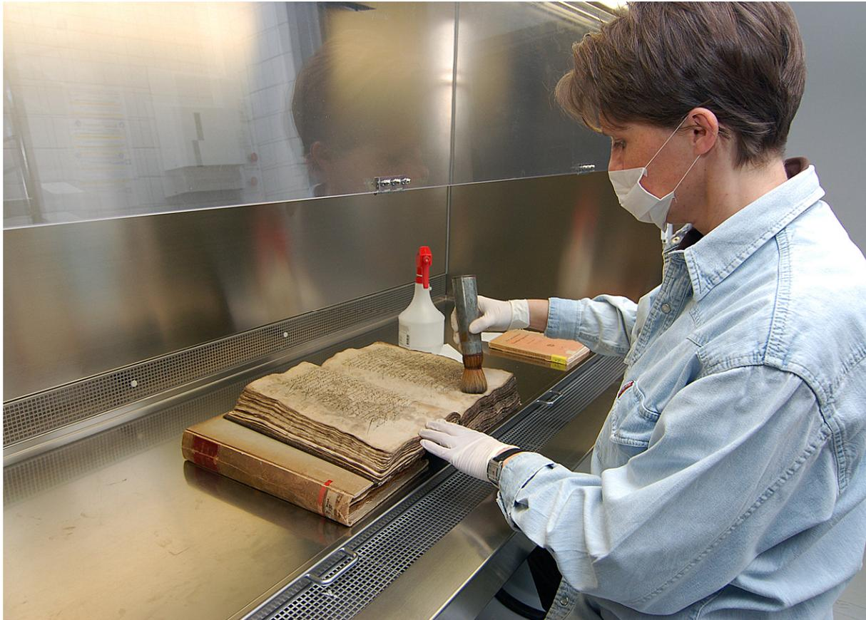
Trockenreinigung sterilisierter ‚Schimmelbände‘ in einer Sicherheitswerkbank mit HEPA-Filter
